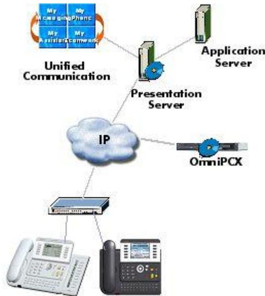
第三方应用必须通过 Presentation 服务器接入 IP touch 话机并在话机显示屏上显示出来。Presentation 服务器作为 presentation 网关并提供给第三方应用一套基于 XML 的显示服务：
